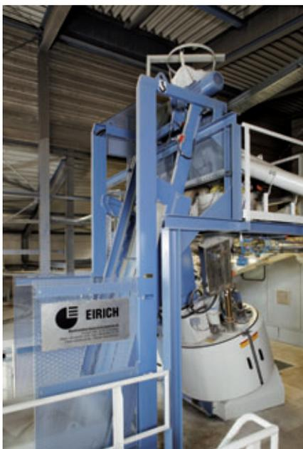
Instalación RV 12 de Eirich para hormigón de paramento
