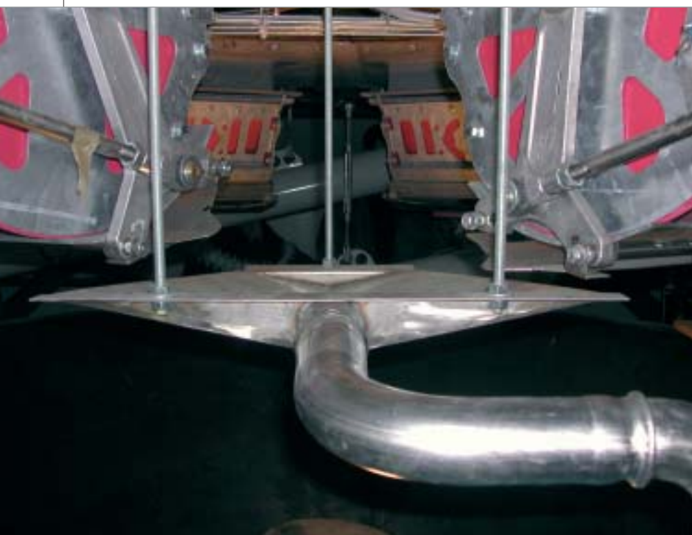
Fig. 6: Los cierres del segmento de dosificación con el dispositivo de acero inoxidable para la retirada del agua sobrante
