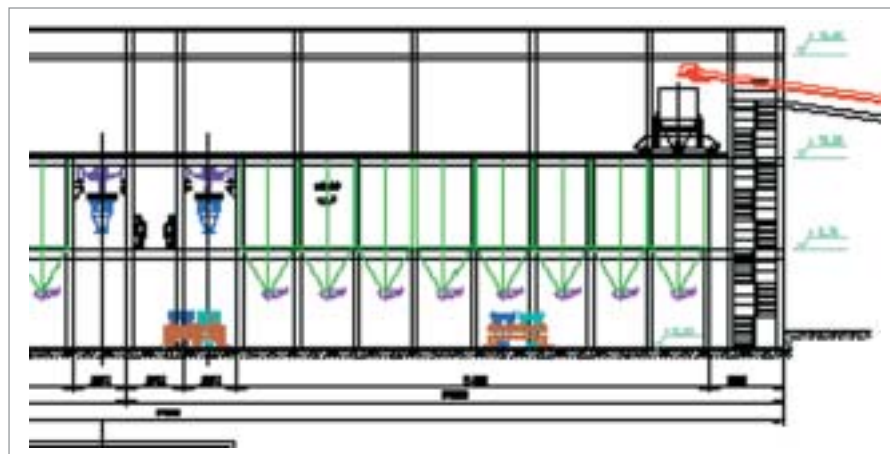
Fig. 9: Distribución, almacenamiento y dosificación de las materias primas
