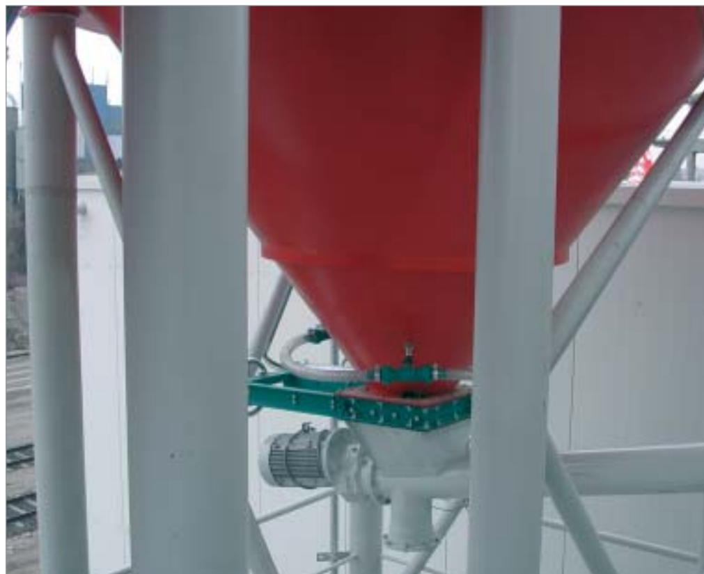
Fig. 5: Un silo de cemento con el dispositivo de aireación, la válvula de bloqueo y el tubo sinfín de la dosificación
