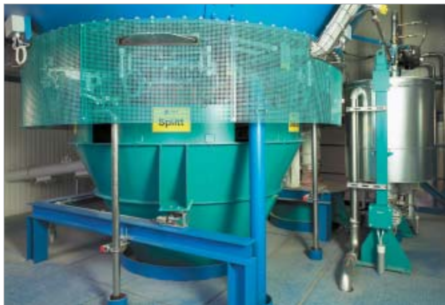
Fig. 7: Las básculas para los áridos, el cemento y el agua
